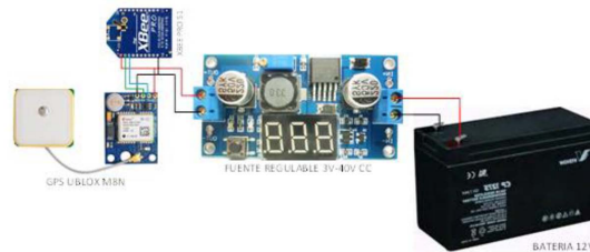
Figura 7. Esquema de conexiones de los elementos de la estación base
