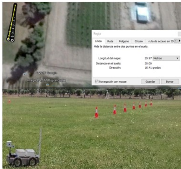
Figura 13. Recorrido lineal realizado por el robot en un espacio abierto
