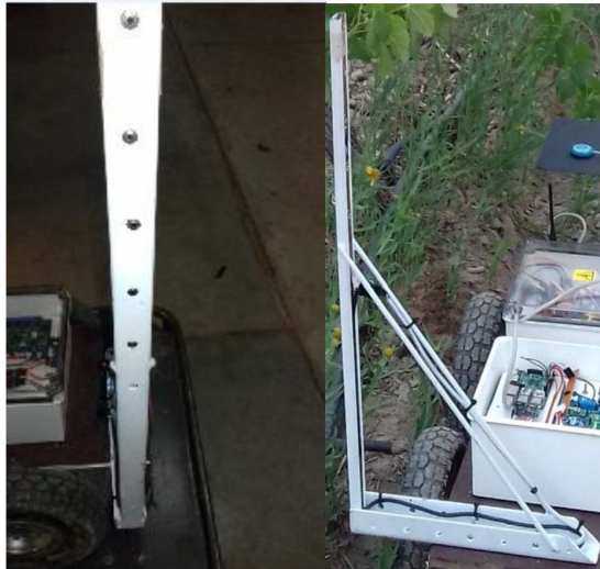
Figura 5. Arreglo de sensores de temperatura, montados sobre la plataforma móvil
