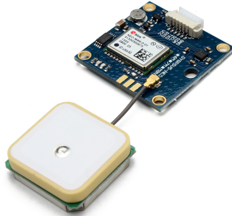
Figura 3. Modulo de GPS Ublox M8N
