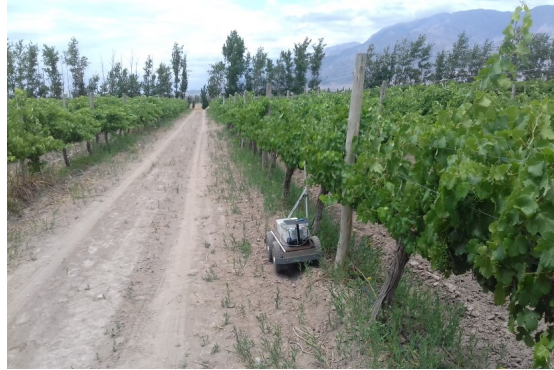
Figura 14. Robot realizando la medición de temperaturas de manera autónoma
